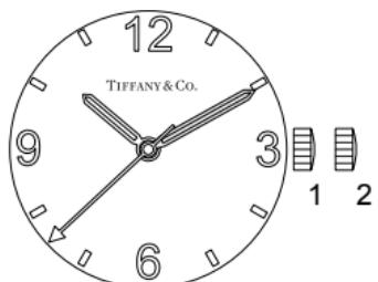
2. *Ajustes de Hora:* Tire de la corona (posición 2). Gire la corona hacia adelante o hacia atrás para seleccionar la hora correcta. Cuando la corona se encuentra en la posición 2, el reloj está en modo «puesta en hora» y el segundero se detiene. Sincronice el segundero pulsando la corona hasta la posición 1 en el instante coincidente con la referencia horaria (0 segundos).
